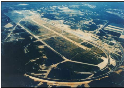
Bau des Siemens-Prüfcenters für Schienenfahrzeuge auf dem ehemaligen Militärflughafen in Heinsberg-Wildenrath (5 Teststrecken von 410 m – 6.083 m Länge)
